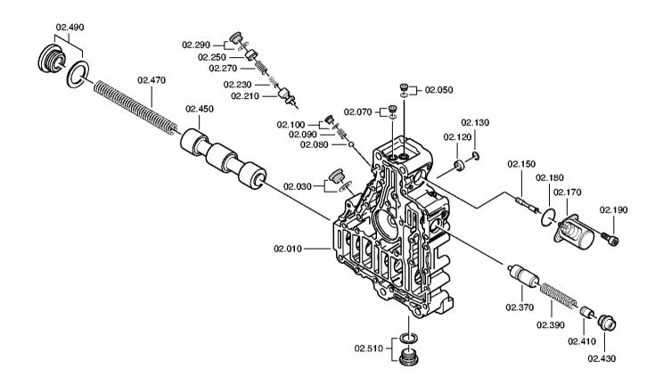
Bildtafel: 078.02.79-1 STEUERUNG 16 S 181 IT / MAN NUTZFAHRZEUGE AG STEUERUNG
