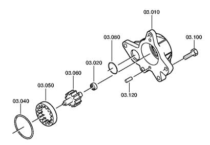
Bildtafel: 078.03.80-1 PUMPE 16 S 181 IT / MAN NUTZFAHRZEUGE AG PUMPE
