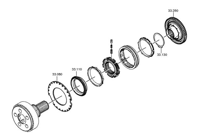
Bildtafel: 068.45.40-1 SYNCHRONISIERG 16 S 181 IT / MAN NUTZFAHRZEUGE AG SYNCHRONISIERG
