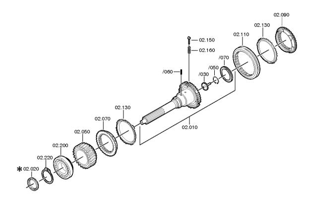
Bildtafel: 068.02.54-1 ANTRIEBSWELLE 16 S 181 IT / MAN NUTZFAHRZEUGE AG ANSCHLUSSPLATTE
