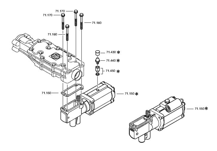
Bildtafel: 068.08.92-1 ABSCHLUSSDECKEL 16 S 181 IT / MAN NUTZFAHRZEUGE AG ABSCHLUSSDECKEL
