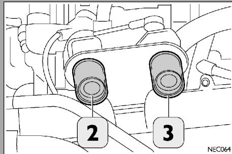
Помните, что для запуска двигателя при откинутой кабине следует нажать кнопку запуска двигателя 2, расположенную под полом кабины (ключ в замке зажигания должен быть повернут в положение MAR).
