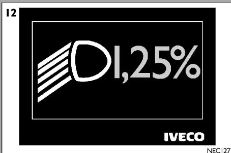
12. Табличка указывает угол наклона луча света фар, которые следует установить при регулировке направления света фар.
