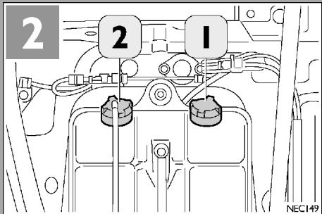
2. Проверьте уровень охлаждающей жидкости. Он должен находиться между отметками MAX и MIN. Дополнительную информацию о том, как проверять уровень охлаждающей жидкости, см. в разделе «Проверка уровня охлаждающей жидкости».
