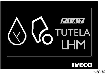
8. При замене жидкости гидропривода откидывания кабины используйте жидкость только того типа, который указан на табличке.
