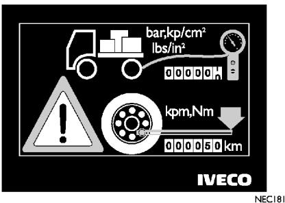
7. Перед началом эксплуатации автомобиля доведите давление в шинах до значений, указанных в руководстве по эксплуатации и техническому обслуживанию. На время транспортировки автомобиля давление в шинах обычно понижается.
