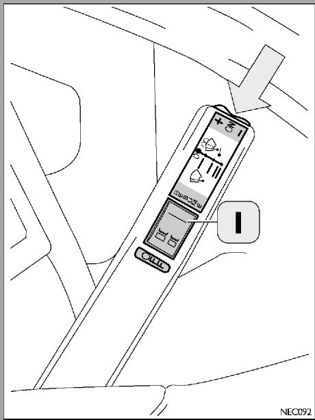
При нажатии педали тормоза, педали сцепления или включении моторного тормоза функция регулировки отключается. То же самое происходит, если заданная скорость не достигается.
