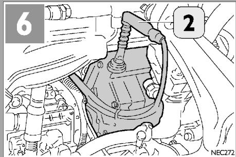
6. Снимите крышку (2) расширительного бачка (отсоединив предварительно датчик) и проверьте уровень жидкости в контуре гидроусилителя рулевого управления. При работающем двигателе и прямом положении колес уровень жидкости должен достигать верхней отметки на щупе. При выключенном двигателе и прямолинейном положении колес уровень жидкости должен находиться на 1-2 см выше верхней отметки на щупе. При необходимости долейте жидкость до требуемого уровня.
