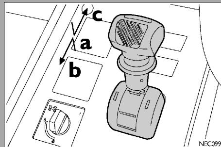
**Вспомогательное устройство для выключения стояночного тормоза**
